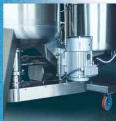
Motorizzazione posta nella parte inferiore della campana filtrante per una rapida manutenzione The centrifugal motor system is located under the vessel chamber for rapid maintenance
